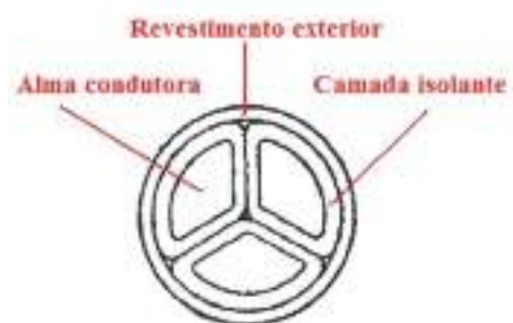
Fig. 40 – Constituição de um cabo multicondutor com alma setorial
