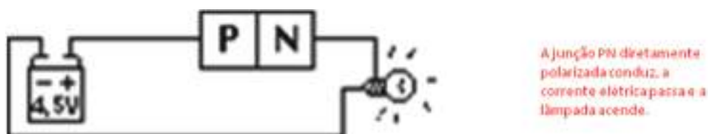
Fig. 24 – Junção P-N diretamente polarizada
